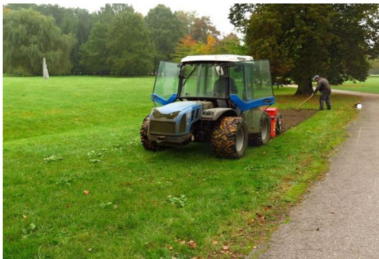
Stroj odstránenie pôvodného trávneho porastu
